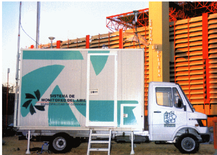
Vista exterior de una Estación Móvil de Monitoreo Automático.
